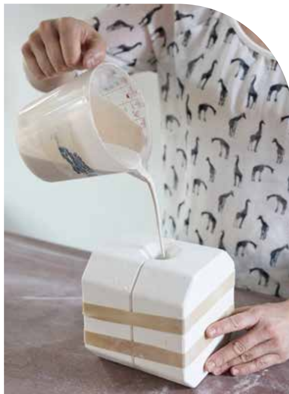
De la porcelaine liquide, également appelée porcelaine de coulage, est versée dans un moule en plâtre. Le moule est ensuite vidé, laissant une fine couche de porcelaine. Après séchage, le moule est retiré avec précaution et la pièce peut être finalisée.
